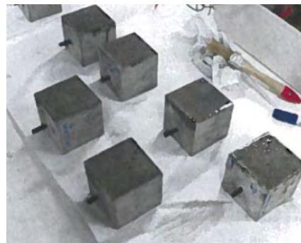
Aplicación de los inhibidores de superficie sobre las probetas de 7x7x7 cm.
