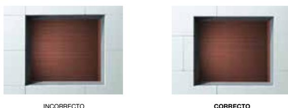
De manera habitual, en rehabilitación los marcos de puertas y ventanas tienen una anchura inferior al espesor del aislante que se coloca en la fachada. En estas situaciones, y siempre que sea aprobado por la dirección facultativa, se puede resolver el puente térmico de las jambas y dinteles, mediante el uso de paneles aislantes con un espesor inferior al que se está colocando en la fachada.
