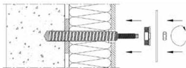
Dejar curar el producto unos 45 minutos a una temperatura de  $20^{\circ}\text{C}$ . Una vez fraguado, retirar la pieza de montaje, colocar elemento de sellado y, posteriormente, el accesorio requerido.
