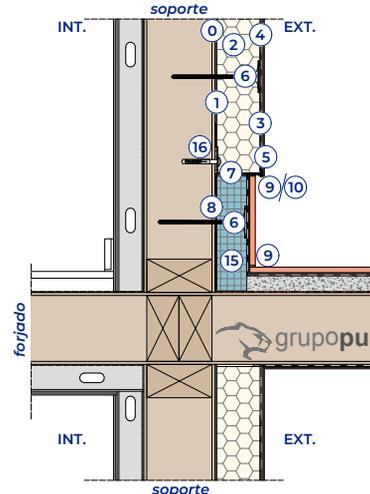
**DETALLE NC: ARRANQUE DEL SISTEMA ACABADO CERÁMICO EN RODAPIÉ**
