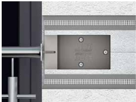
El ángulo de anclaje se fijará a la fachada con los tornillos Traditerm Inox. A4 Delta PT 10x60 mm para asegurar un correcto reparto de cargas de la forma en la que se observa en la imagen. De esta manera, Traditerm ISO Corner se colocará a la vez que las placas aislantes.
