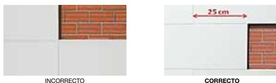
La formación de las esquinas de la fachada, se realiza con las placas entrecruzadas, según la imagen siguiente:
