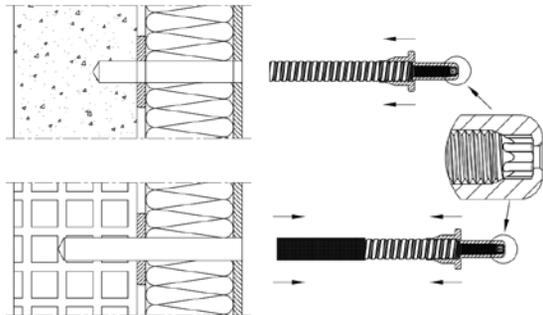
Cortar Traditerm ISO BAR con la longitud deseada y colocar sobre la cabeza la pieza de montaje. En el caso de elementos de construcción perforados, como muros de fábrica, se colocará el tamiz en el extremo de Traditerm ISO BAR para evitar la fuga de adhesivo. Introducir la pieza en la perforación y girar con una llave SW 19 hasta llegar al tope. De nuevo, extraer la pieza, dejando el tamiz en el interior en el caso de haber sido utilizado.
